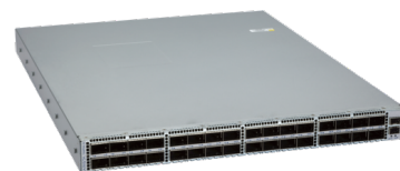
Arista 7050PX4-32S: 32x 400G OSFP ports, 2 SFP+ ports
